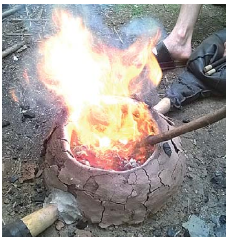
Tavba mědi v tavicí peci a odlévání předmětu do keramické formy Copper melting and casting in a ceramic mould
