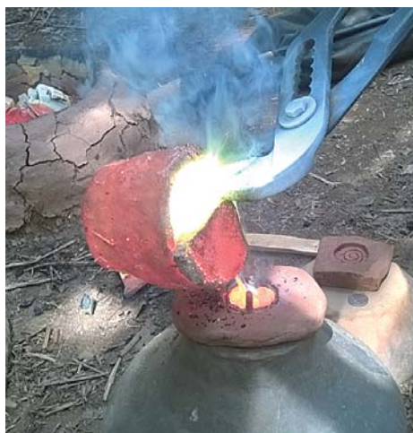
Tavba mědi v tavicí peci a odlévání předmětu do keramické formy Copper melting and casting in a ceramic mould
