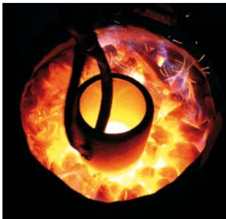
Tavba bronzu v tyglíku. Foto OP Bronze smelting in a crucible
