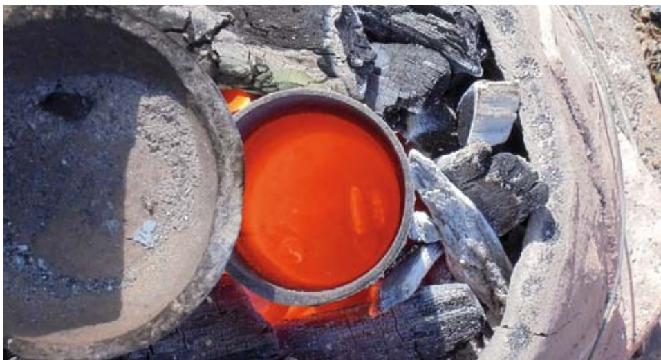
Zkušební tavba recyklovaného skla v mobilní peci. OP Test melting of recycled glass in a portable furnace
